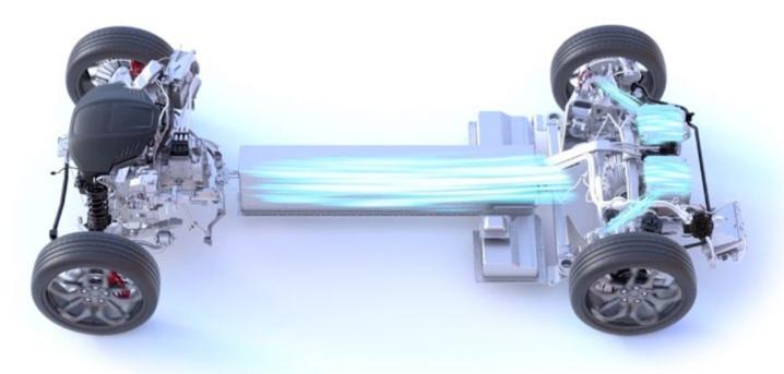
REVERO GT não é 100% elétrico, mas antes um híbrido plug-in: além da bateria e do motor elétrico conta ainda com um motor BMW 1.5 de três cilindros a gasolina, o mesmo do BMW i8. A combinação destes elementos confere ao desportivo 536 cavalos e 745 Nm de binário, que lhe permite acelerar dos 0-100 km/h em 3,9 segundos.
