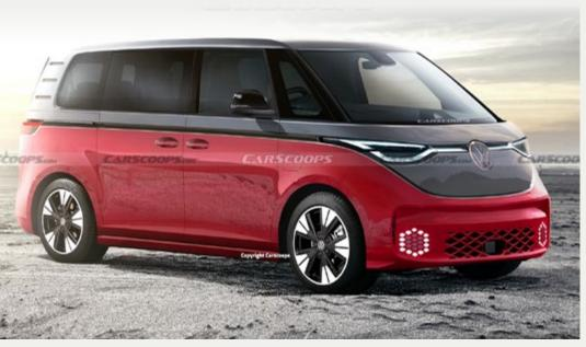
Este modelo recorre a um sistema de propulsão exclusivamente elétrico composto por dois motores, para oferecer 369 cv de potência e tração integral permanente.
