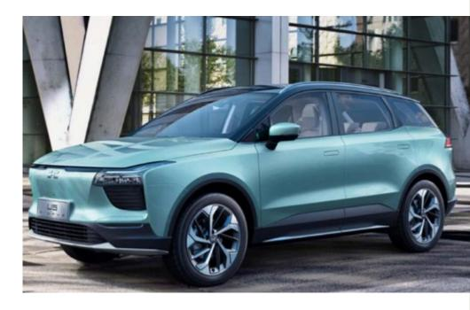
O Aiways U5 promete a capacidade de carregar entre 30 e 80% em cerca de 27 minutos, num posto de carga rápida. Já numa tomada AC e utilizando o carregador de 6,6 kW que modelo possui, serão necessárias cerca de 8 horas para carregar dos 20% aos 100%.
