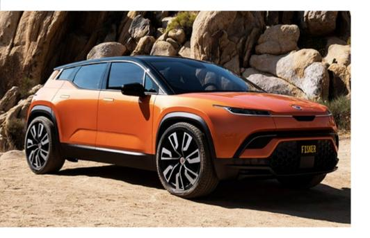
Este modelo é um SUV 100% elétrico que Fisker oferecerá duas químicas de células de bateria para o seu modelo Ocean: o modelo de base estará equipado com células de bateria de ião lítio num um pacote touring range fornecido pela CATL. A autonomia será de 402 km. Já as versões Ultra e Extreme terão uma bateria Hyper Range com células de cobalto de níquel-manganês, também da CATL. Para estas versões, a autonomia será de 547 km e 563 km, respetivamente.
