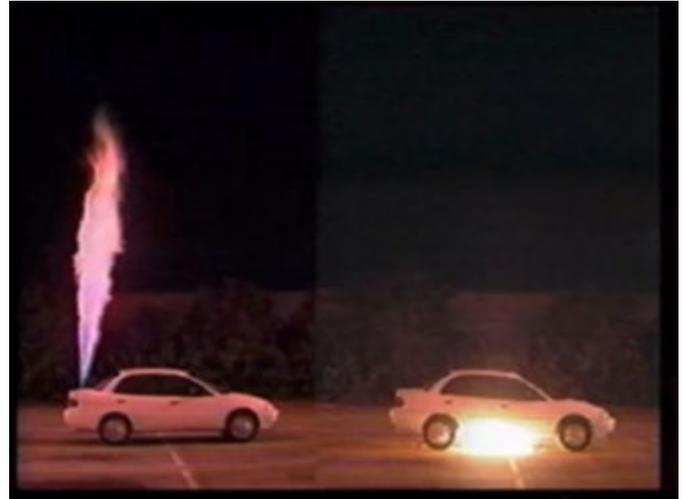
Foto 2 - Tempo: 0 min, 3 seg - Ocorre a ignição de ambos os combustíveis. Velocidade de fluxo do hidrogénio: 2100 SCFM. Velocidade de fluxo da gasolina: 680 cc/min
