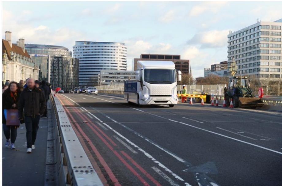
metade das emissões de CO2 do que um veículo equivalente convencional com a mesma capacidade de carga, e que possa viajar pelo menos 95 km sem quaisquer emissões de escape. Depois 7.5t Electric Truck, a Tevva Motors prepara um novo camião elétrico, também com capacidade de carga de 7,5 tone-
